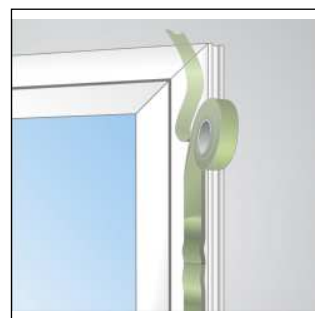
Монтаж стыка при разрыве ленты.
