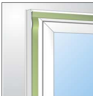
Монтаж ленты на оконной конструкции.
