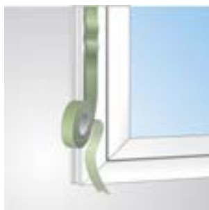
Рис.2 В местах соединения краев ПСУЛ оставляйте припуск с двух сторон.
