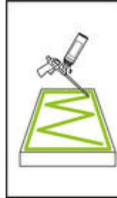
Grosses, mittiges M oder W auf die EPS Dämmplattenrückseite sprühen. Klebeflächenanteil im angedrückten Zustand mindestens 40% der Dämmplattenfläche.
