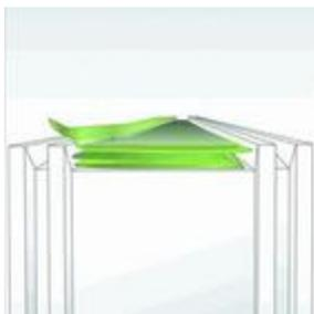
Bild 2: Montageposition im PVC-Profil
