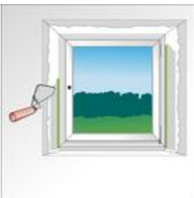
Bild 13: Einputzen und glattstreichen
