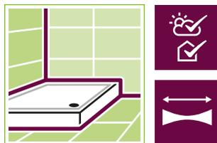
Dieser 1-komponentige Silikonichtstoff ist aufgrund seiner sehr guten Feuchtraum-, Witterungs-, und Alterungsbeständigkeit speziell geeignet zum elastischen Abdichten von Anschluss- und Dehnungsfugen in Sanitär- und Feuchträumen sowie im Metallbau-/ Glasbereich, z.B. an gefliesten Wänden, an Badewannen, Brausetassen, Duschtrennungen usw.
