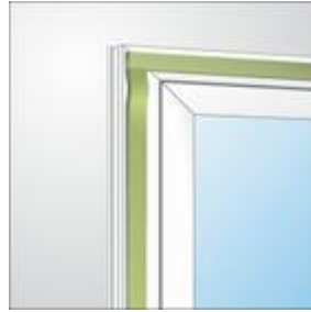
Bild 1: Bandverlegung bei der Fenstermontage
