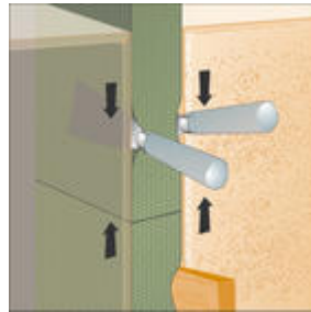
Stuik aansluiting verticale voegen
