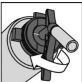
AA210 Spray Nozzle een kwartslag draaien.
