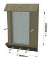
5-ös kép: Biztonsági csavarok 1 szárnyas ablak esetén.
