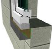
1-es kép: Készre szerelt illbruck PR007 ablakszerelő tok profil illbruck PR008 szigetelő ékkel.
