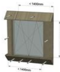
6-ös kép: Biztonsági csavarok 2 szárnyas ablak esetén.
