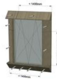
7-es kép: Biztonsági csavarok 2 szárnyas balkon ajtó esetén (3 oldalon 1 csavar per profildarab).
