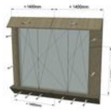
8-as kép: Biztonsági csavarok 3 szárnyas balkon ajtó esetén
