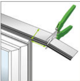
4-es kép: A saroknál a fóliát egy szélességnyivel engedje túl, és vágja el.
