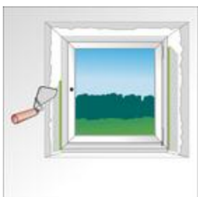
13-as kép: Vakolja be a rácsot, és simítsa el a felületet.
