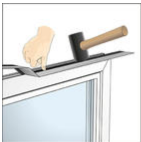
14-es kép: Nyomja bele a kédert az ablakkeret nútjába.
