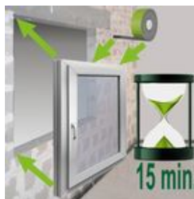
Ilustracja 4: W ciągu 15 minut należy zamontować okno.
