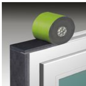
Ilustracja 3: TP652 przykleić na ramie - szarą stroną taśmy kierować do wewnątrz. W narożach przykleić z naddatkiem.
