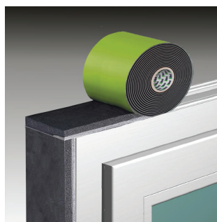
Fig 3 : coller TP652 sur le châssis (côté gris vers l'intérieur). Les bandes en parties hautes et basses recouvrent les bandes verticales.
