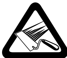
Fig 5 : Le côté non-tissé de la membrane est imprimé au moyen du picto ci-dessus, qui indique que la grille de cette face peut-être enduite de mortier... , hors de la zone de dilatation de la membrane (soufflet), uniquement sur la zone de collage
