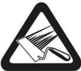
Afb. 8: Folie met aandrukroller aanrollen.
