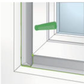
Afb. 7: De folie bij overlappen met SP025 verkleven.
