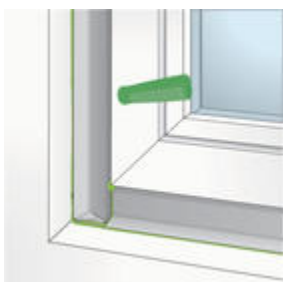
Afb 6. De folie bij overlappen met SP025 verkleven
