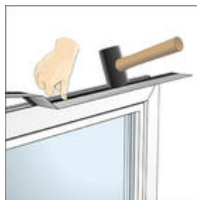
Afb. 9 Het geschikte profiel met rubberhamer aanbrengen.
