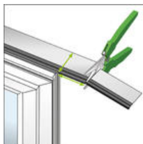
Afb. 10 De folie met ca. 5 cm overlengte afknippen.
