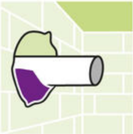
Voor het vullen van leidingdoorvoeren.
