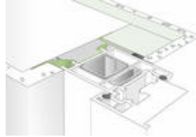
6-os kép: fólia rögzítése belső és külső oldalon.
