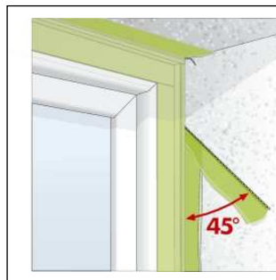
Bild3: Überstehende Folie mit dem Reißfaden unter 45° abreißen.
