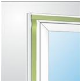
Bild 1: Eckauslegung bei der Fenstermontage
