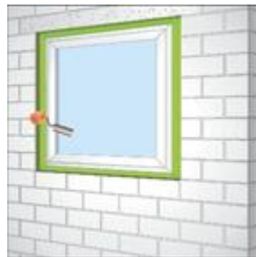
Bild 8: Folie mit Andruckroller anrollen
