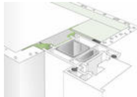
Bild 6: Befestigung der Folie innen wie Außenseite
