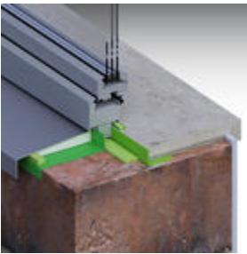
Verarbeitung des Fensteranschlusses mit FM230.
