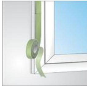
Bild 3: Stumpfstoss bei der Fenstermontage
