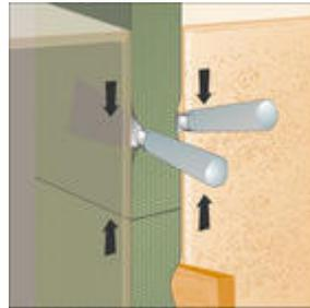
Bild 2: Stumpfstoss im Massivbau
