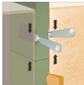
Bild 2: Stumpfstoss im Massivbau
