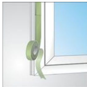
Bild 3: Stumpfstoss bei der Fenstermontage
