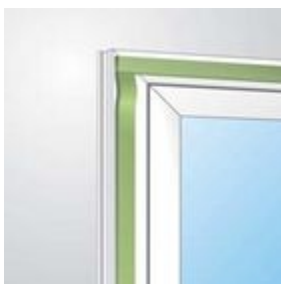
Bild 3: Bandverlegung bei der Fenstermontage
