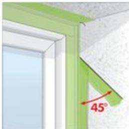
Bild3: Überstehende Folie mit dem Reißfaden unter 45° abreißen.
