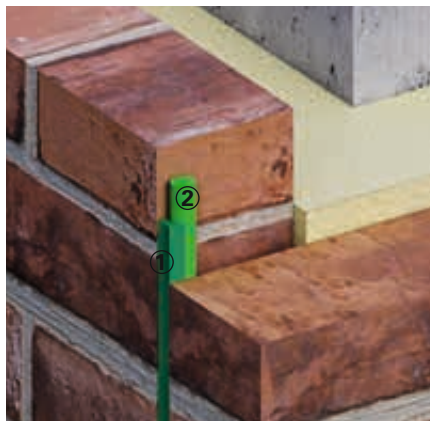
① SP525 Hochbaufugen-Dichtstoff ② PR102 Rundschnur PE
