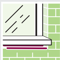
Lepení parapetů a klempířských prvků
