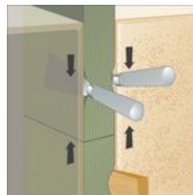
Bild 2: Stumpfstoß im Massivbau
