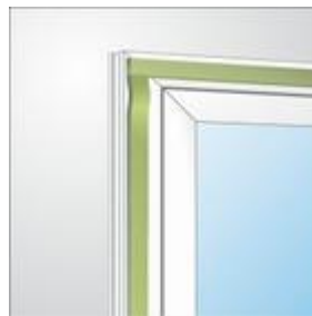
Bild 1: Bandverlegung bei der Fenstermontage
