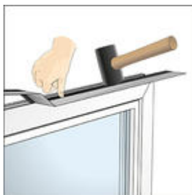
Afb. 9 Het geschikte profiel met rubberhamer aanbrengen.
