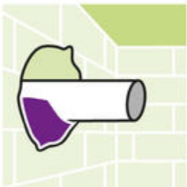
Voor het vullen van leidingdoorvoeren.
