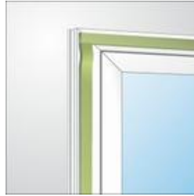
Rysunek 1: Sposób wyłożenia taśmą naroży okna.
