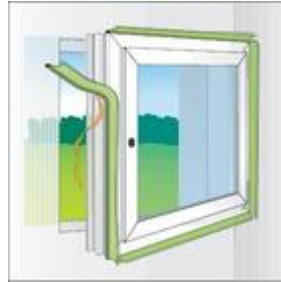
Bild 1: Befestigung der Selbstklebung von TP001 illmod i am Rahmen.
