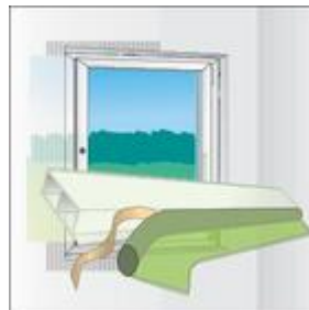
Bild 3: Befestigung der Selbstklebung von TP001 illmod i an der Kammerleiste.
