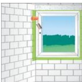
Figure 4 : maroufler la membrane sur le mur.
