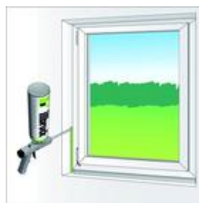
Ilustracja 3: Wypełnić pianką fugę okienną
