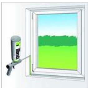
Ilustracja 3: Wypełnić pianką fuge okienną
