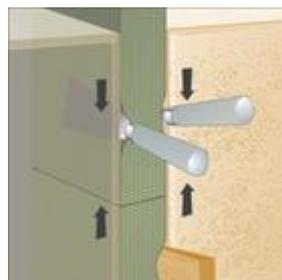
Bild 2: Stumpfstoß im Massivbau
