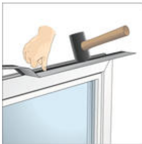
ilustracja 1: Odpowiednią folię kedrową umieścić w zewnętrznych rowkach ościeżnicy.
