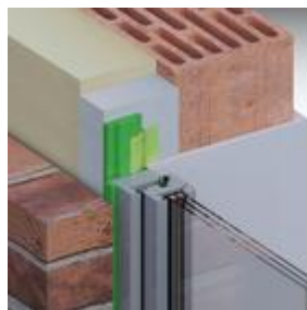
Rys.3 Rozwiązanie: ME350 Folia okienna wewnętrzna VV FM330 Pianka elastyczna Perfekt Taśma rozprężna TP600 illmod 600
