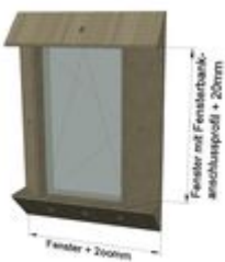
Bild 4: Maße Zuschnitt Zarge für 10 mm Fuge
