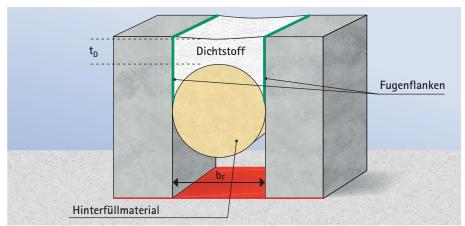
Eine Haftung darf nur an den grünen Fugenflanken erfolgen. Die zusätzliche Haftung am roten Untergrund (Dreiflankenhaftung) wird durch den Einsatz von geeignetem Hinterfüllmaterial vermieden.
