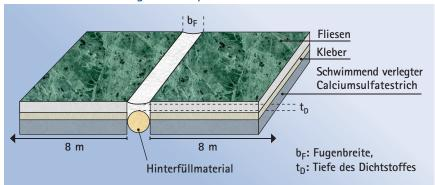
1. Berechnung der Längenänderung  $\iota(T)$ , die der Dichtstoff auffangen muss.
