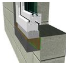
Ilustracja 1: illbruck PR007 profil instalacyjny z PR008 klinem izolacyjnym.
