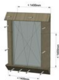
Ilustracja 6: Wkręty zabezpieczające - okno dwuskrzydłowe.
