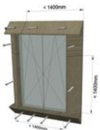
Ilustracja 7: Wkręty zabezpieczające - okno balkonowe.
