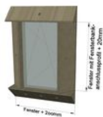
Ilustracja 4: Wymiary przecięcia profilu instalacyjnego dla 10 mm spoiny
