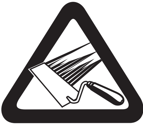
Fig 5 : Le côté non-tissé de la membrane est imprimé au moyen du picto ci-dessus, qui indique que la grille de cette face peut-être enduite de mortier..
