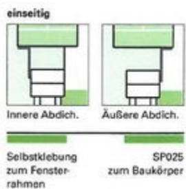
Bild 13: E = einseitig: ein Selbstklebestreifen befindet sich als Selbstklebung zum Fensterrahmen auf der glatten, unbedruckten und dämmstoffseitigen Folienseite.
