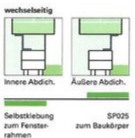
Bild 14: W = wechselseitig: ein Selbstklebestreifen zum Fensterrahmen befindet sich auf der überputzbaren, bedruckten und sichtbaren Folienseite.
