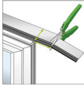
Bild 7: Folie im Eckbereich mit einem Breitenüberstand abschneiden
