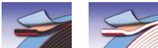
Les mousses PVC à cellules fermées sont des bandes adhésives compressibles, avec un adhésif à tack immédiat, sensible à la pression, et protégé par un liner empêchant leur allongement lors de l'application.
