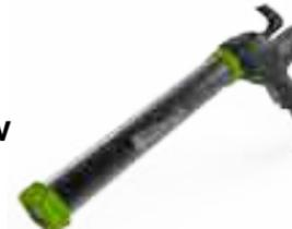
Les pistolets illbruck Batteryflow sont des pistolets électriques à 10.8V fonctionnant sur batterie lithium de longue durée, rechargeables en moins d'une demi-heure. Ces pistolets sont spécialement conçus pour extruder des mastics & colles de viscosité faible et moyenne, types silicones, acryliques, hybrides... Ils facilitent le traitement des joints de grande longueur, apportant une application homogène et en toute autonomie.
