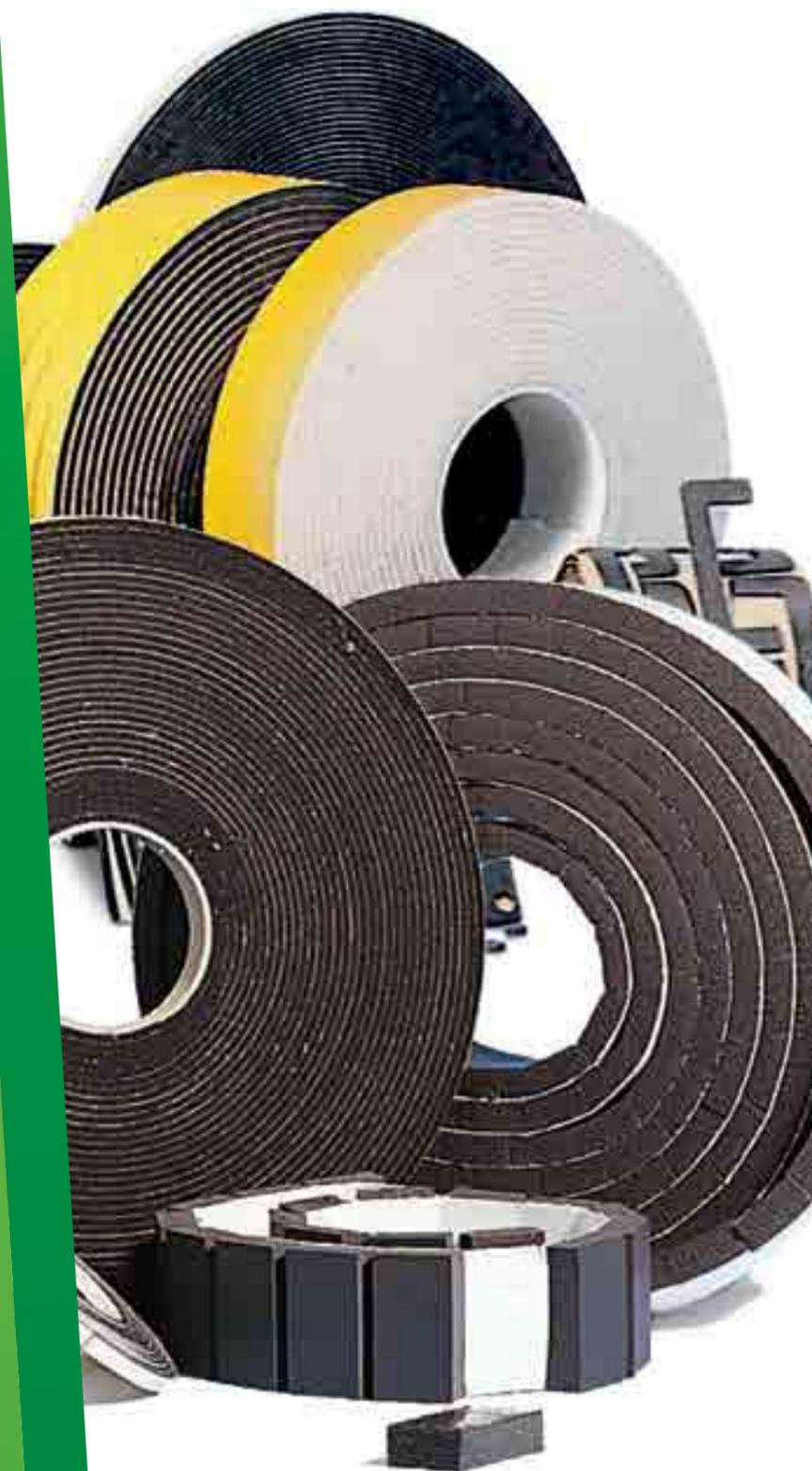
Les mousses PVC à cellules fermées sont des bandes adhésives compressibles, avec un adhésif à tack immédiat, sensible à la pression, et protégé par un liner empêchant leur allongement lors de l'application.
