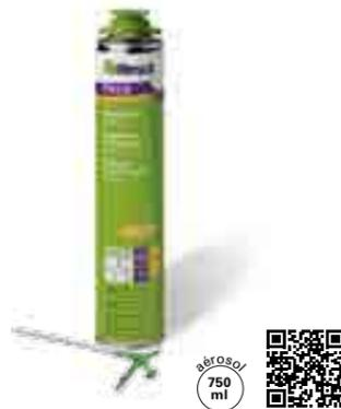
Mousse polyuréthane expansive, monocomposante, durcissant avec l'humidité de l'air. Utilisée pour le remplissage de cavités et en complément d'isolation pour les cloisons, panneaux isolants, combles, au pourtour des tuyauteries.
