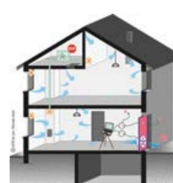
Le système est à nouveau inversé et la mesure effectuée en phase de dépression conformément à la norme NF EN 13289 et ISO 9972. Dans le standard français, tous les essais sont effectués avec un débit de fuite de 50Pa mais on ne prend pas en compte le ratio "n<sub>50</sub>". Le ratio utilisé est appelé "Q<sub>4PaSurr</sub>", quotient calculé du débit de fuite sous 4Pa divisé par la surface de parois froides.
