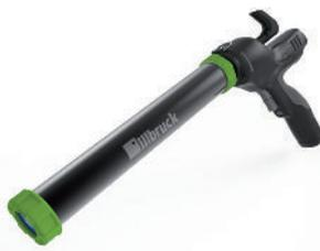
Las pistolas de aplicación illbruck incorporan baterías eléctricas de litio recargable de 10,8V que son recargables en menos de media hora y son de larga duración. Estas pistolas están especialmente diseñadas para la extrusión de selladores y adhesivos de baja y media viscosidad, tipo silicona, acrílicos, polímeros o híbridos... Facilitan la realización de juntas de gran longitud, proporcionando una aplicación coherente y reduciendo cualquier esfuerzo personal.
